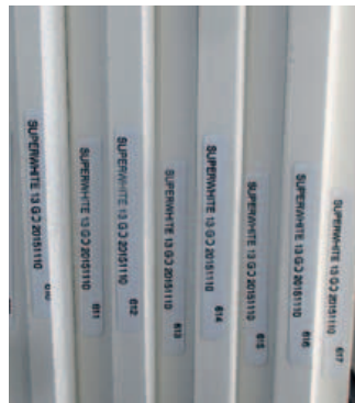
Particolare dei tag Rfid sulle lastre finite di Stone Italiana
