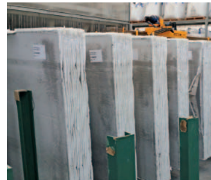
Pacchi di lastre grezze con etichette Rfid presso lo stabilimento di Zimella di Stone Italiana
