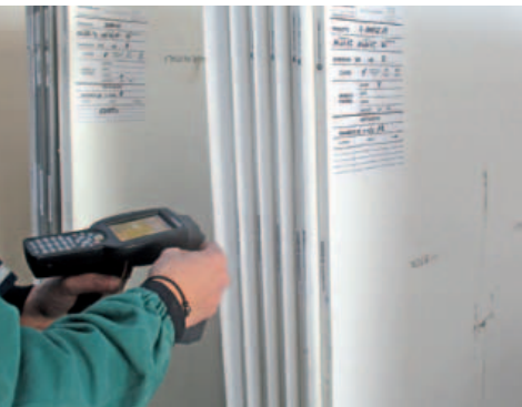
Letture dei tag Rfid apposti sulle lastre con il mobile computer Merlin Cross-Dipole presso lo stabilimento di Gorizia di Stone Italiana
