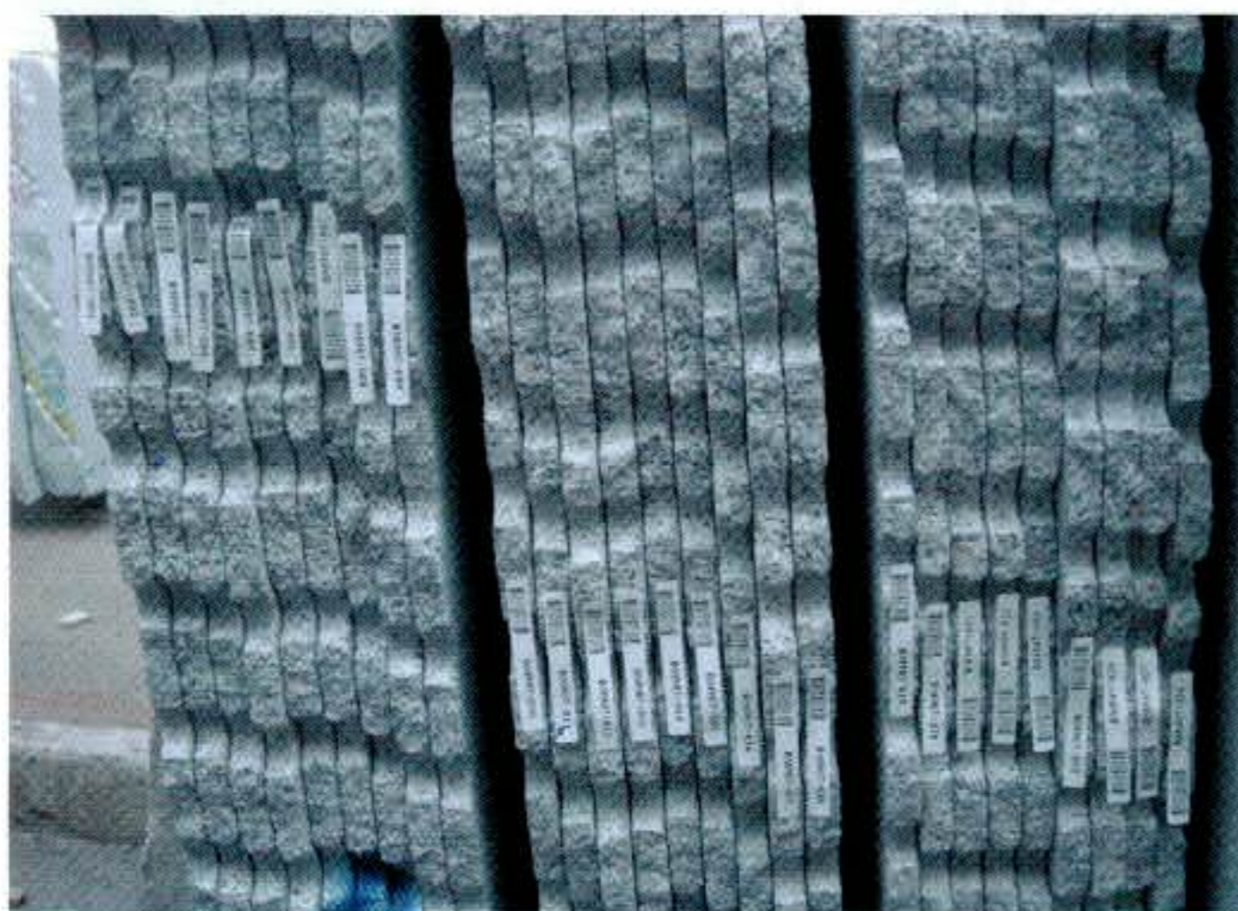
Bild 1 Um bereits geschnittene Platten zu identifizieren, werden die Transponder auf die dünne Innenseite der Platten geklebt. Diese enthalten die jeweiligen Produktionsdaten wie Material, Herkunft, Produktionsdatum etc.
