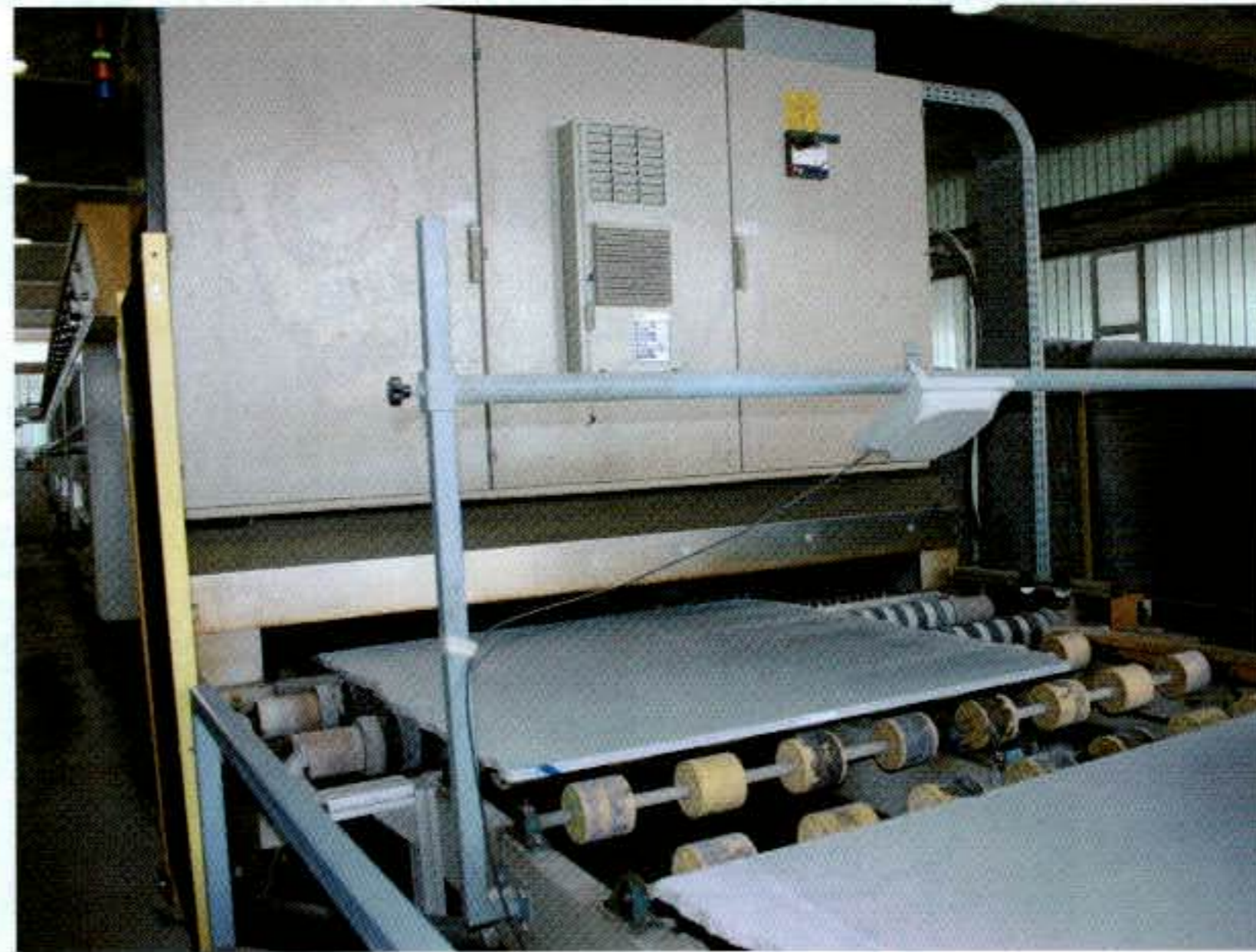
Bild 3 Durch den aufgebrauchten Transponder sind alle noch verbleibenden Produktionsschritte der Steinplatte stets in Echtzeit nachvollziehbar. Bilder: Feig
