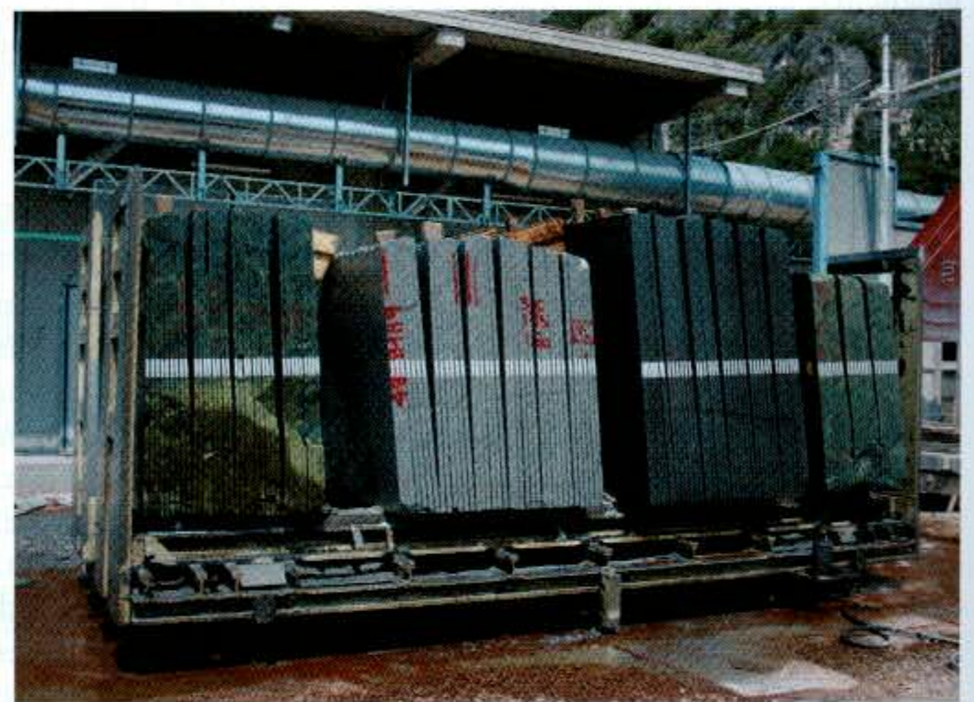
Bild 2 Da die Steinplatten bis zu einem Jahr im Freien gelagert werden, mussten spezielle RFID-Tags mit einem besonderen Kleber ausgewählt werden.
