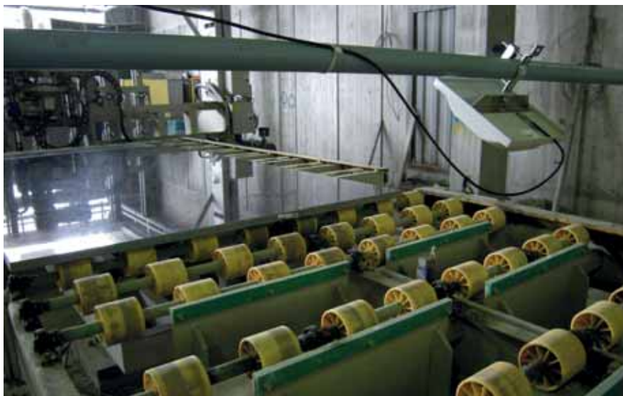
Linea di produzione in Antolini: l'antenna Rfid rileva in automatico il tag apposto sulla lastra
