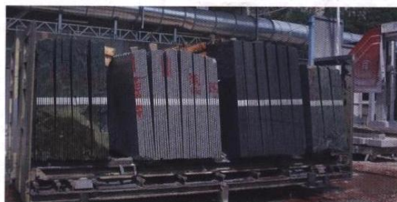
An den Transportgestellen für die Natursteinplatten sind Mount-on-Metal-Tags befestigt, die alle Platten-IDs auf dem Wagen zusammenfassen.
